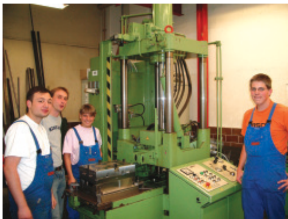
Beteiligte Jugendliche an der Spritzgießmaschine (o.), das selbst entwickelte Werkzeug in der Maschine (l.).
