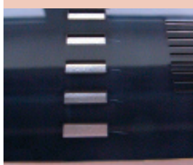
Bild 3 zeigt eine Blende, bei der aufgrund der Durchbrüche sowie der notwendigen Mehrfachenbindung eine Vielzahl von Bindenähten entsteht, die bei der Hochglanzpolitur als Fließmarkierungen in Form von Kerben zu erkennen sind (siehe Bildausschnitt in Abb. 4).
