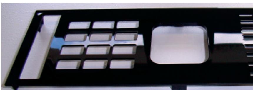
Bild 3 zeigt eine Blende, bei der aufgrund der Durchbrüche sowie der notwendigen Mehrfachenbindung eine Vielzahl von Bindenähten entsteht, die bei der Hochglanzpolitur als Fließmarkierungen in Form von Kerben zu erkennen sind (siehe Bildausschnitt in Abb. 4).
