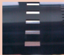
Bild 3 zeigt eine Blende, bei der aufgrund der Durchbrüche sowie der notwendigen Mehrfachenbindung eine Vielzahl von Bindenähten entsteht, die bei der Hochglanzpolitur als Fließmarkierungen in Form von Kerben zu erkennen sind (siehe Bildausschnitt in Abb. 4).
