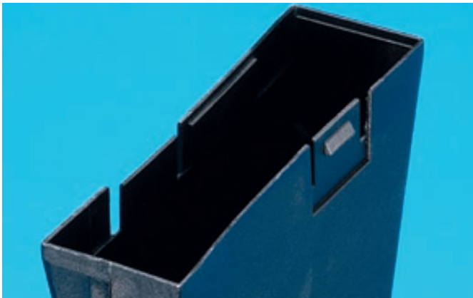
Verzug an einem kastenförmigen Bauteil
