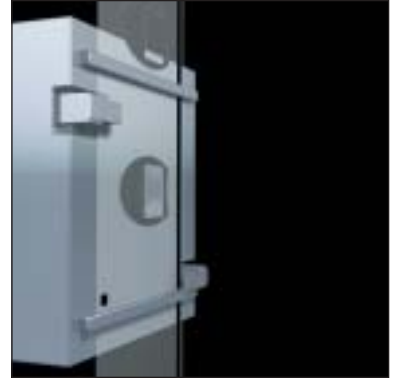
Positionierung der Folie im Werkzeug Positioning of the foil in the mold
