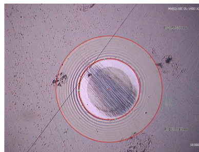
CVD beschichtete Probe aus 1.2343
