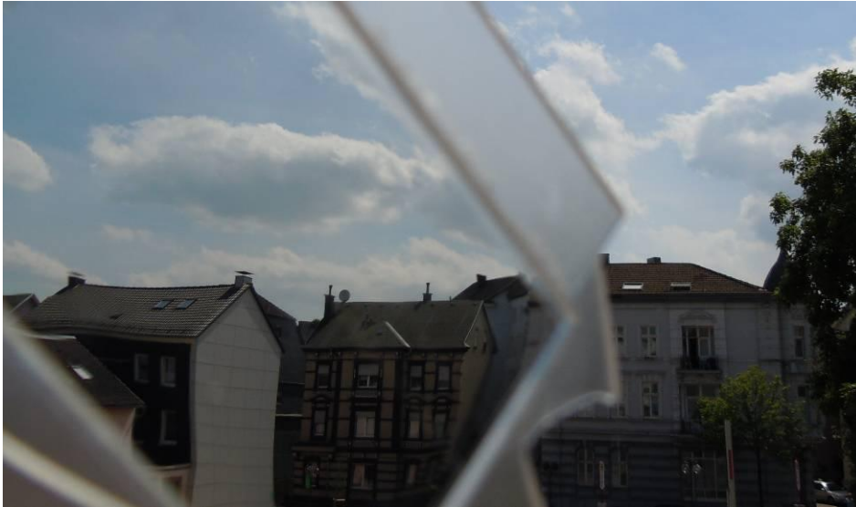
Mit einem PMMA hinterspritztes Dünnglas, Dicke 0,1mm.
